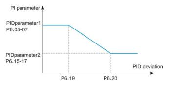
Fig.6-27 PID parameters switchover
